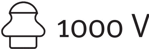
Bild 7: Kennzeichnung von elektrisch isolierenden Schuhen für Arbeiten an Niederspannungsanlagen
